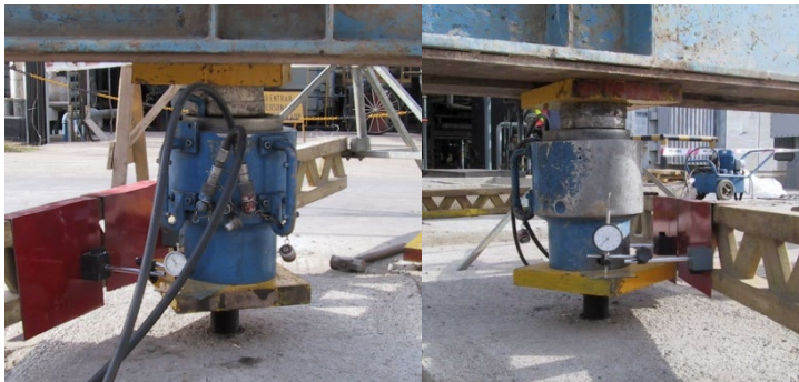
Foto 2: Detalle del montaje del ensayo a tracción.
