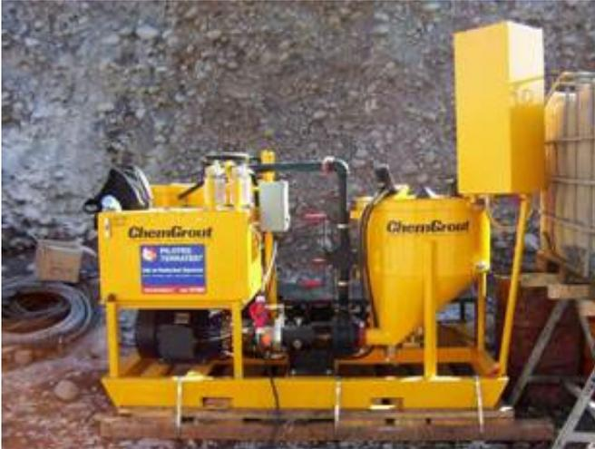
**Planta Mezcladora Inyectora
